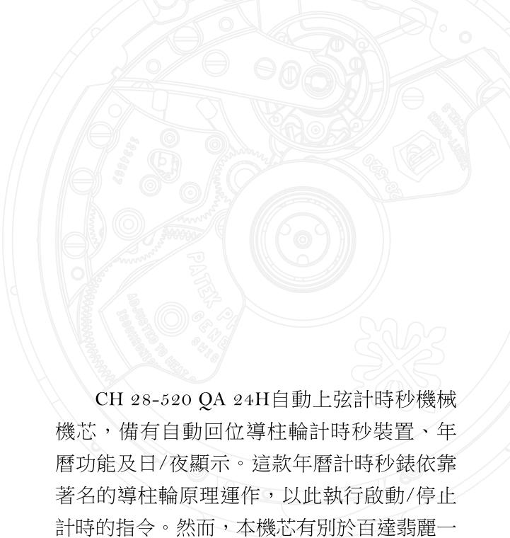
CH 28-520 QA 24H自動上弦計時秒機械機芯，備有自動回位導柱輪計時秒裝置、年曆功能及日/夜顯示。這款年曆計時秒錶依靠著名的導柱輪原理運作，以此執行啟動/停止計時的指令。然而，本機芯有別於百達翡麗一貫的導柱輪計時秒裝置，採用了一項非凡的嶄新設計：裝置內的夾鉗不再依賴計時秒齒輪組來控制由槓桿固定的離合器齒輪，而是轉用一個碟形的離合器組件，藉此傳達（開始計時功能）或阻隔（停止計時功能）第四齒輪與計時秒針之間的動力傳輸活動。新設計讓佩戴人士可經常保持計時秒針運作而無損腕錶速率準確程度，造就百達翡麗的年曆計時秒錶不需如不少計時秒錶那樣，在錶面特設小三針附屬顯示盤顯示秒數。
