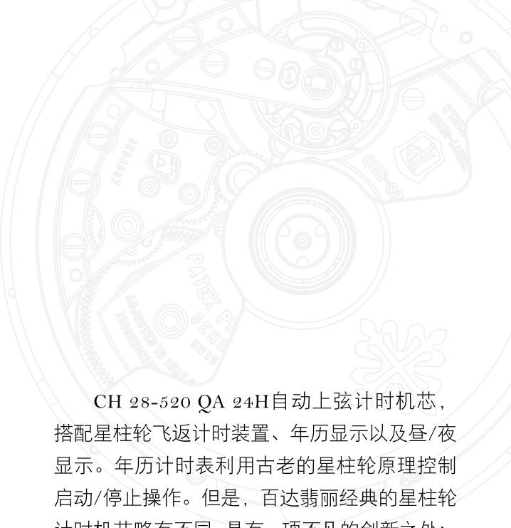
CH 28-520 QA 24H自动上弦计时机芯，搭配星柱轮飞返计时装置、年历显示以及昼/夜显示。年历计时表利用古老的星柱轮原理控制启动/停止操作。但是，百达翡丽经典的星柱轮计时机芯略有不同，具有一项不凡的创新之处：夹钳不会控制计时齿轮系中安装叉杆的离合轮的运转，而是作为在碟形离合器上，令其传输（计时装置运转）或切断（计时装置停止）第四齿轮与计时指针之间的动力。这种解决方案非常可靠，可将计时指针用作连续秒针，而不影响腕表的走时精度。因此，百达翡丽年历计时腕表无须再设置很多计时腕表上常见的小秒针表盘。
